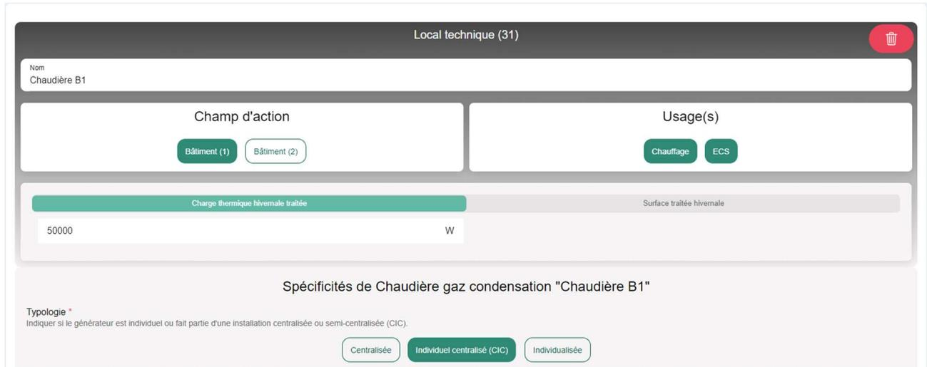
Figure 16 : Chaudière Gaz à condensation uniquement pour le bâtiment 1 en Semi-centralisé (CIC), mais double service
